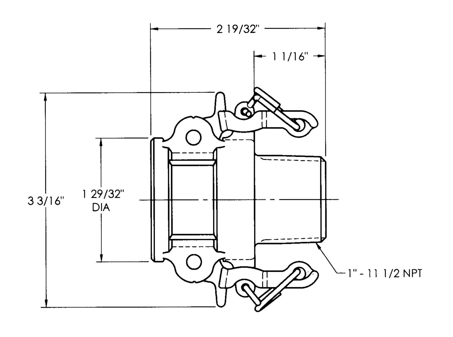
AB100 - ALUMINUM BB100 - BRASS IB100 - MALLEABLE IRON
